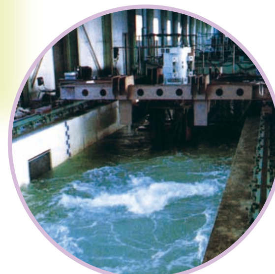
回流水槽での実機試験 (Tank Test)
